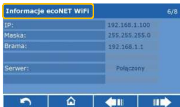
Obr. 4 Okno „Informacje” jako důkaz bezdrátového připojení mezi internetovým modulem ecoNET300 a sítí WiFi – přiřazené adresy.
